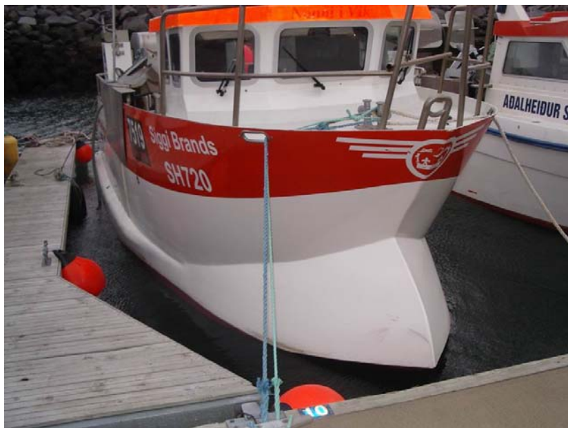
Bilde 19 Ekstremt eksempel på forlengelse av vannlinje
