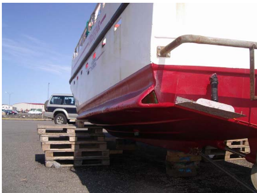
Bilde 20 Dempeanordning for å redusere rullebevegelser
