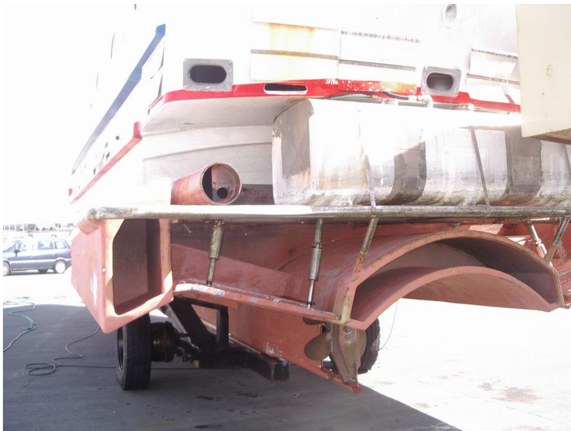
Bilde 16 Forlengelse av bunn som ikke gir oppdrift, samt forlengelse av arbeidsdekket.
