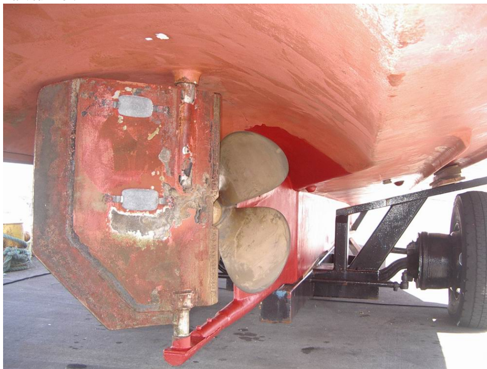
Bilde 15 Eksempel på uheldig recess med skarp kant i forkant av propell
